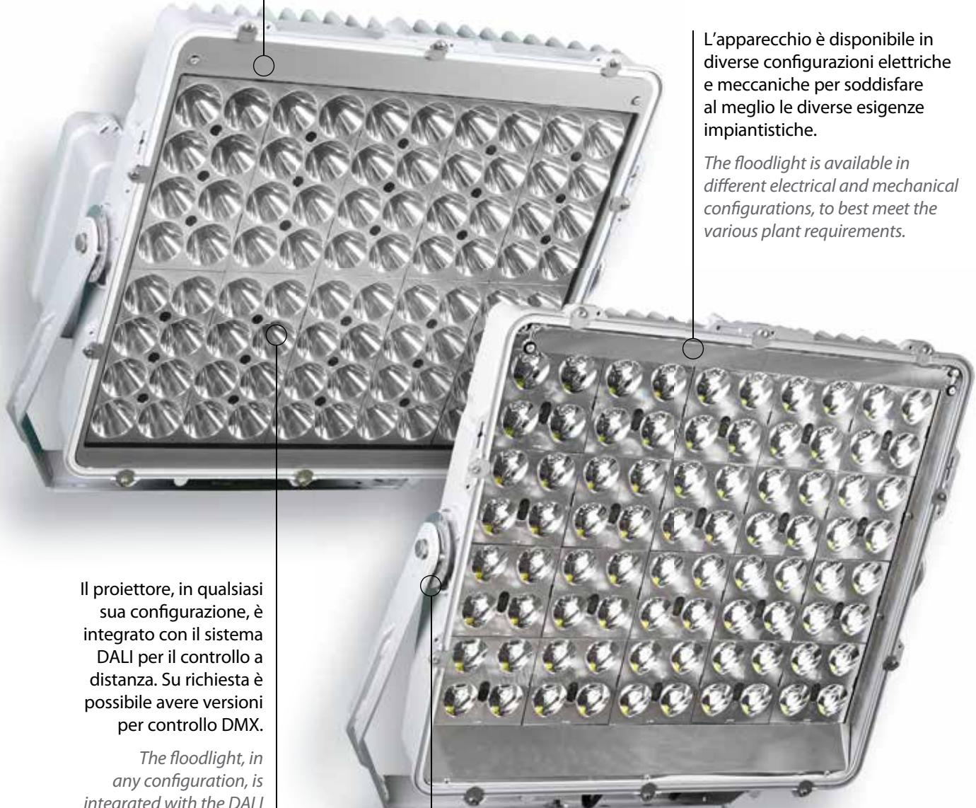
Proiettore per l'illuminazione di grandi aree sportive (HDTV), grandi aree ed areoporti con tecnologia LED High Power su circuito stampato in alluminio altamente dissipante termicamente MCPCB (Metal Core Printed Circuit Board).
